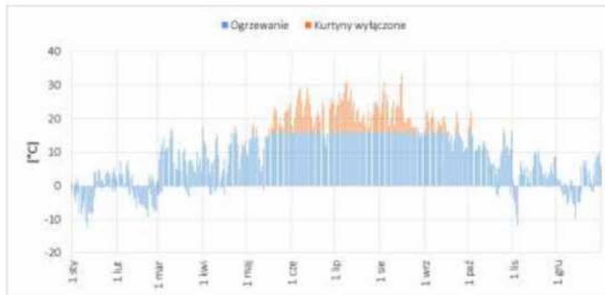
Wykres 1. Roczny godzinowy profil temperaturowy z podziałem na temperatury poniżej i powyżej 16°C
