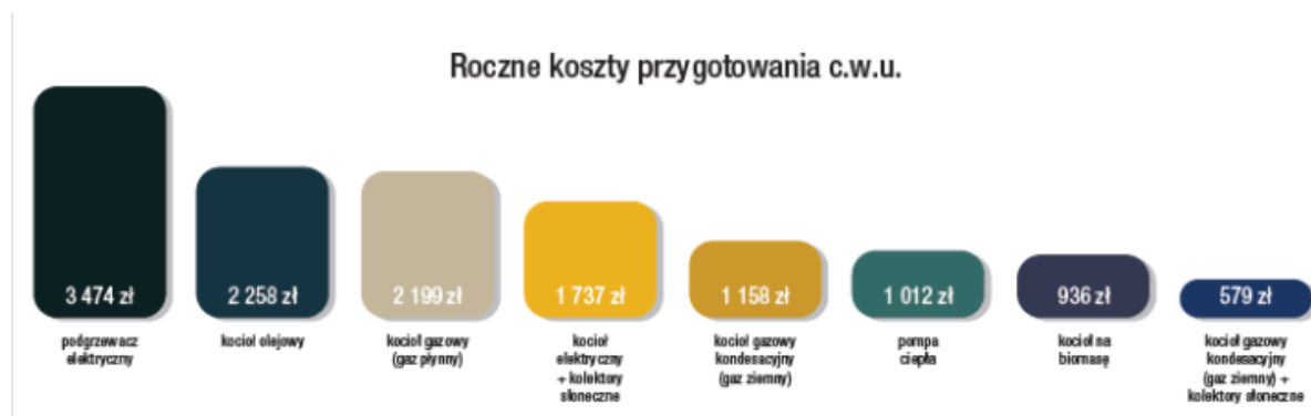
Rysunek 2. Porównanie rocznych kosztów podgrzewania c.w.u. dla 5-osobowej rodziny zużywającej 175 l wody o temperaturze 55°C w ciągu doby: źródło: [3]
