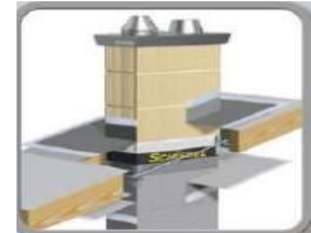
Uszczelnienie Likwidacja mostków termicznych
